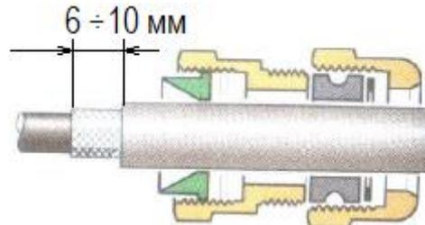
г) наденьте детали 3 и 2 на внутреннюю изоляцию кабеля и вставьте конструкцию в стакан 1
