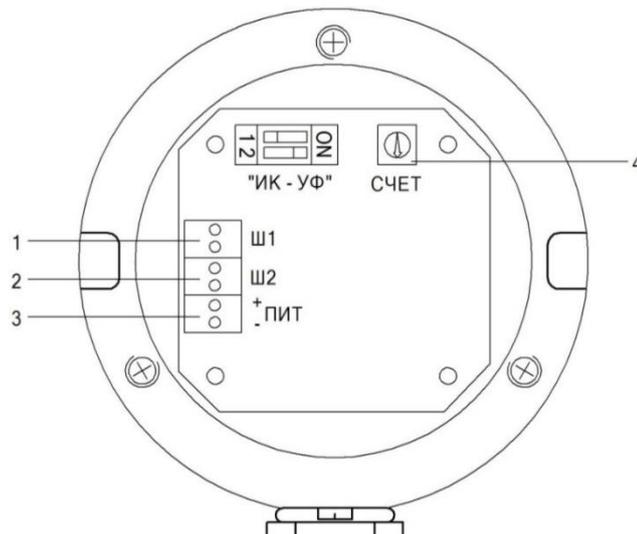
1 – клеммная колодка «Ш1»; 2 – клеммная колодка «Ш2»;
