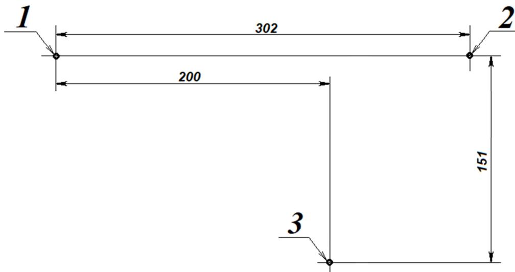
1, 2 - места крепления саморезов для навешивания корпуса БРП1;
