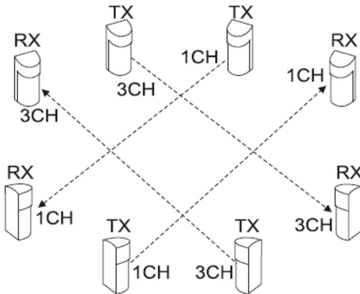
TX - излучатель; RX - приемник
