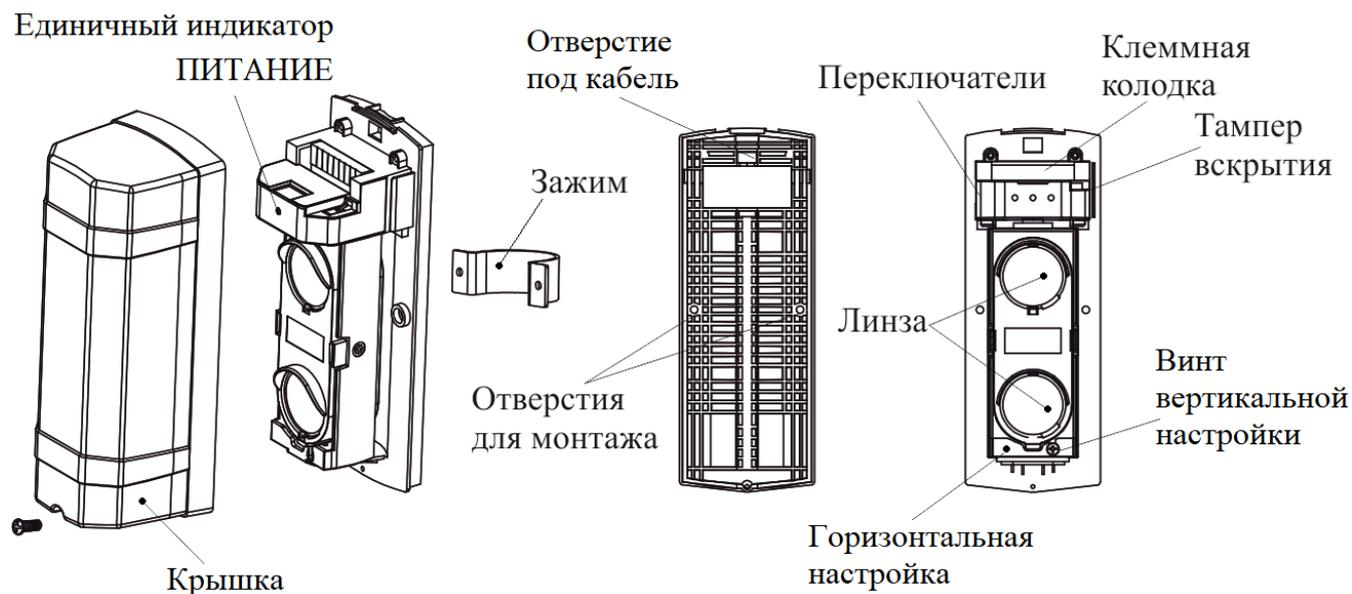
Рисунок 1.4 - Общий вид излучателя
