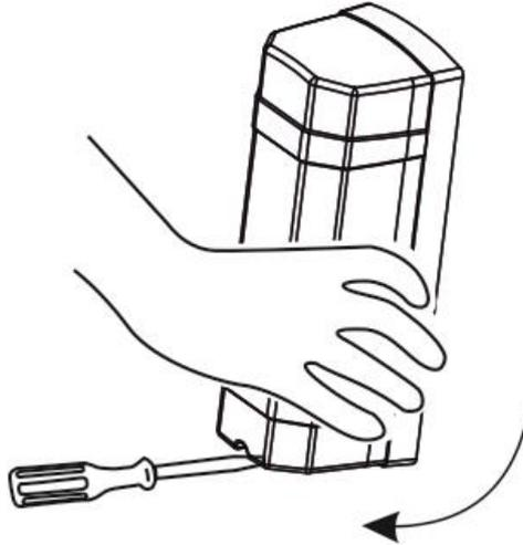
Рисунок 2.8 - Порядок отсоединения крышки от базового основания
