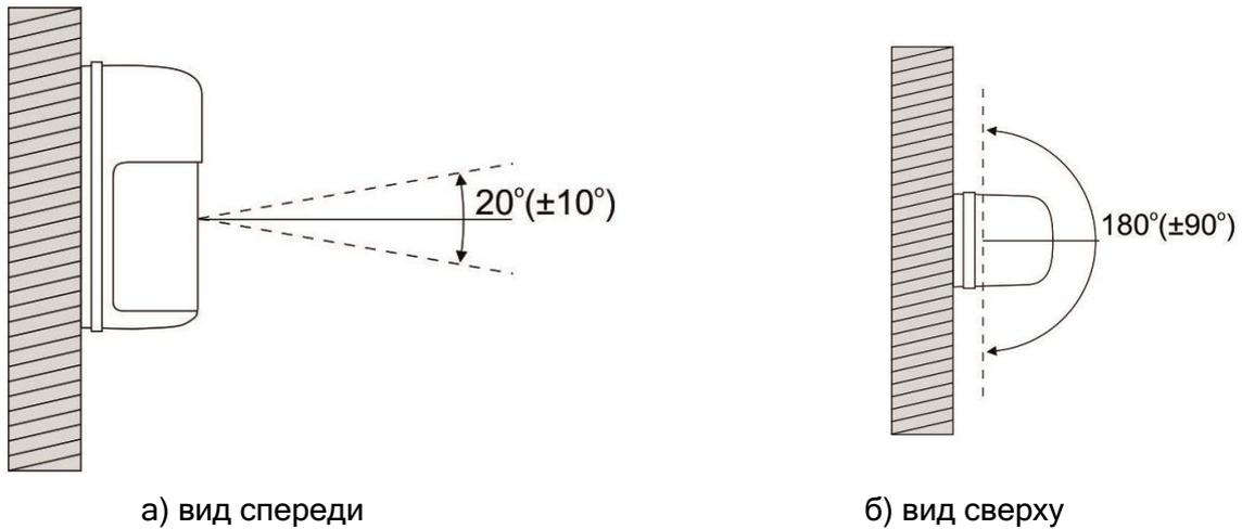
Рисунок 2.1 - Углы наклона оптической оси луча
