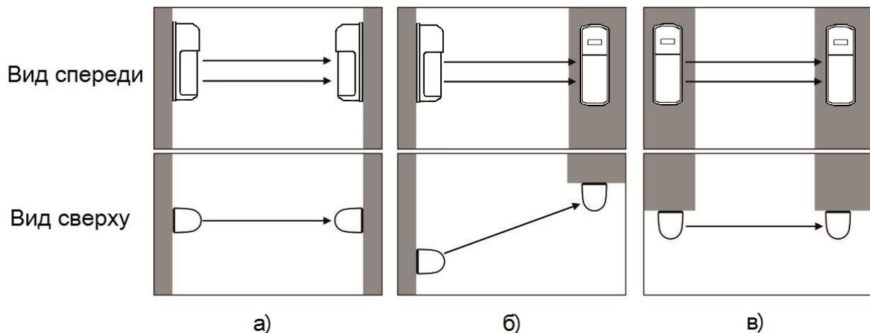
Рисунок 2.7 - Варианты расположения извещателей под разными углами
