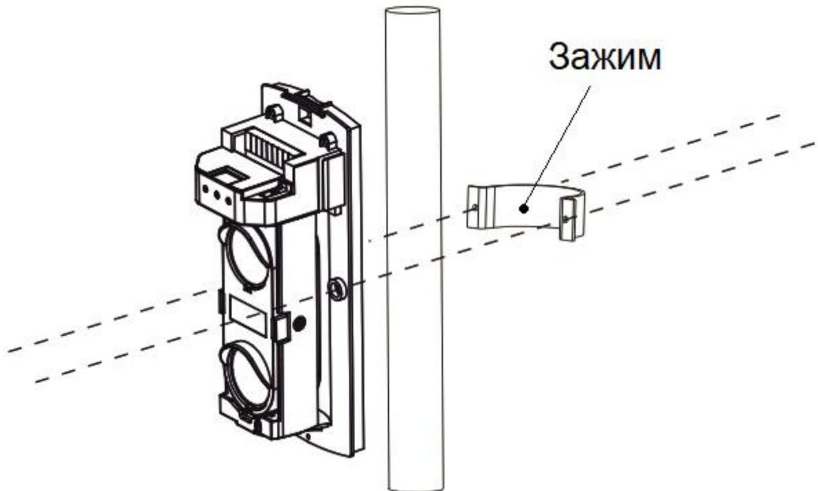
Рисунок 1.6 -Крепление базового основания к монтажной трубе с помощью зажима
