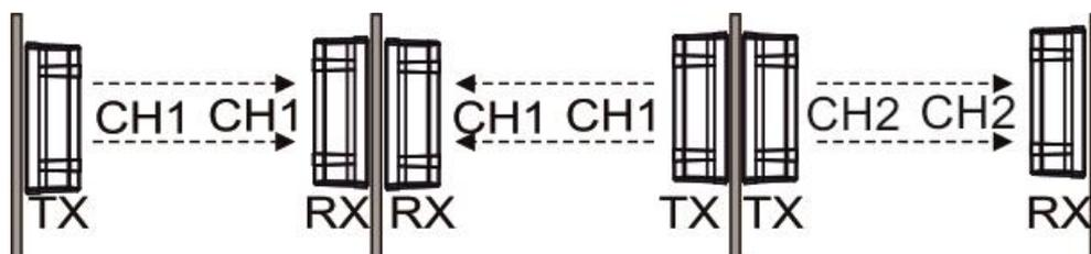
TX - излучатель; RX - приемник
