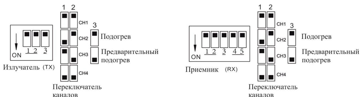
Рисунок 2.11 - Переключатель каналов
