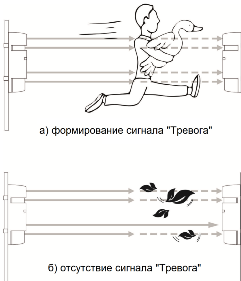
Рисунок 1.3 - Принцип действия извещателя
