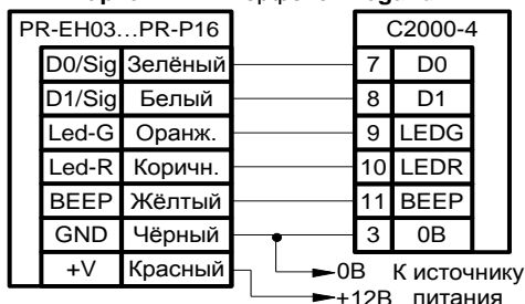
Рисунок 14. Схема подключения считывателей PR-EH03, PR-EH05, PR-EH09, PR-EH16 PR-P05, PR-P09, PR-P16.
