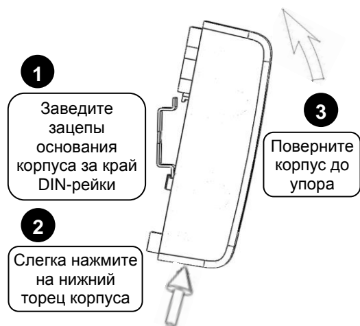
Рисунок 3. Крепление блока на DIN-рейку
