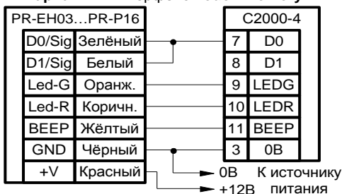
Рисунок 14. Схема подключения считывателей PR-EH03, PR-EH05, PR-EH09, PR-EH16 PR-P05, PR-P09, PR-P16.
